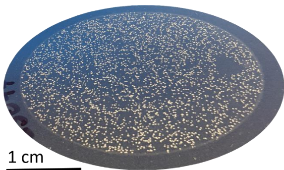
Exponierter Detektor (Makrofol®) nach Ätzprozess
